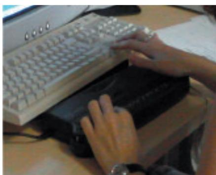
2. Dettaglio barra Braille. L'analista adopera il sintetizzatore vocale combinato con la barra breille.
